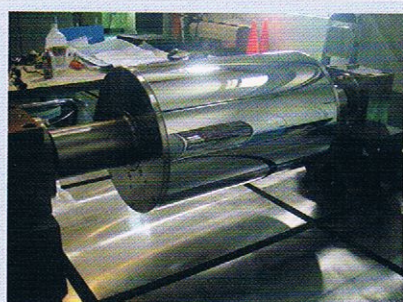
鏡面電鍍サクシヨンスリーブ。工場によって得意分野、 特化した技術は異なる
